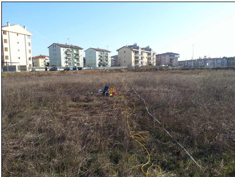
Array sismico MASW
